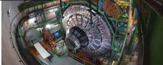
Установка сверхпроводящих магнитов для CMS
